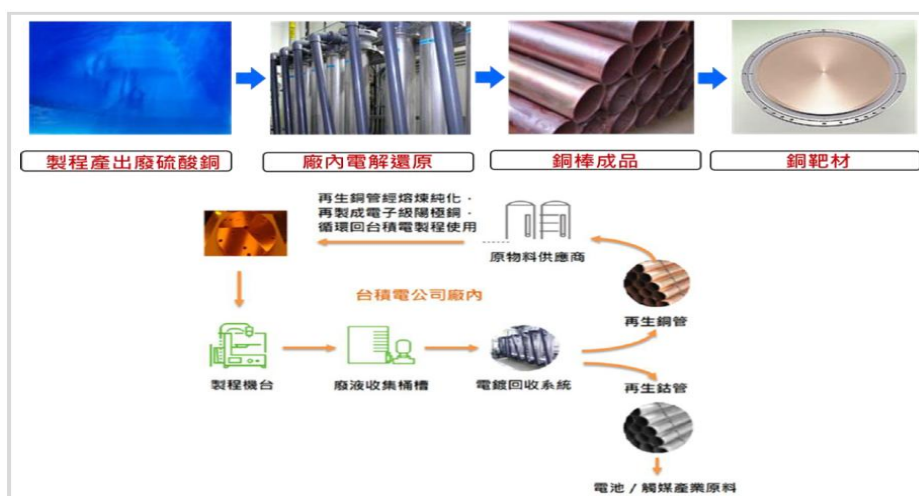
圖五：半導體晶片製造銅廢液資源化
