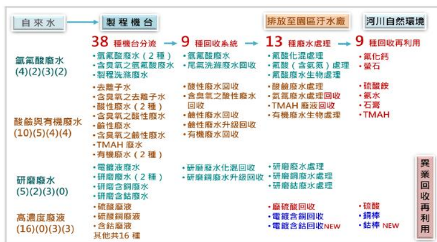
圖四：半導體晶片製造廢液處理
